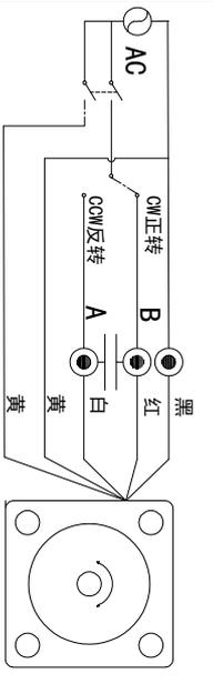
黄线为刹车线, 电压默认为AC220V/110V(其它电压可定制需单独接电源)
